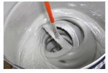
en la Tabla No. 1, o en el envase y agite mecánicamente por medio de taladro acoplado con una propela de agitador, o manualmente por medio de una espátula hasta que se hayan mezclado las dos partes perfectamente.
