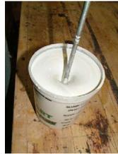
Agregar la parte "B" a la parte "A", en las proporciones indicadas en la Tabla No. 1, o en el envase y agite mecánicamente por medio de taladro acoplado con una propela de agitador, o manualmente por medio de una espátula hasta que se hayan mezclado los dos partes perfectamente.
